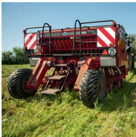
Ce semoir, de 3 mètres de large, creuse 17 sillons par passage. Une performance qui permet aux agriculteurs de planter 20 hectares de luzerne en quelques jours.
