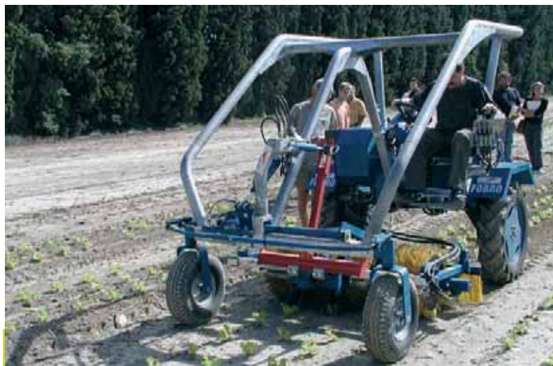
Les désherbeuses à brosse sont utilisées surtout pour désherber des légumes à haute valeur.
