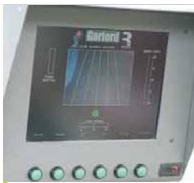
Console avec le moniteur, on peut distinguer la trame représentant les ranges de la culture.
