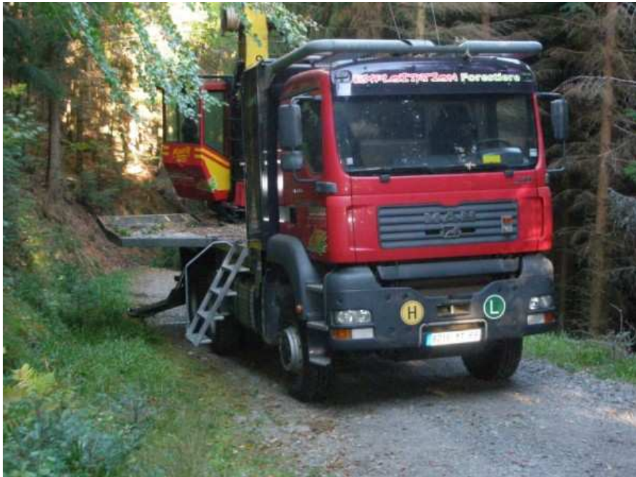
Un câble-mât Woody sur camion équipé d'une grue et d'une tête de bûcheronnage. Cet ensemble déployé sur la route forestière, permet de treuiller vers l'amont des épicéas entiers qui sont façonnés mécaniquement à l'arrivée du câble
