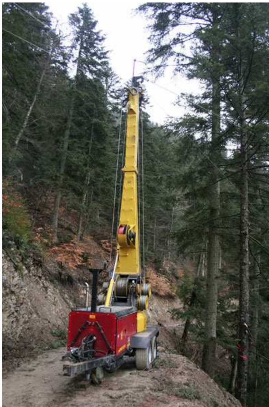
Un câble-mât de moyenne capacité positionné sur une route forestière étroite. Dans ce cas, il est monté sur remorque routière et doté de son propre moteur thermique.
