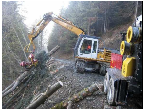
Dans celle-ci une pelle mécanique avec grue et tête assure à la fois le façonnage et la manutention des bois. On notera la forte pente vers l'aval et la faible largeur de route.
