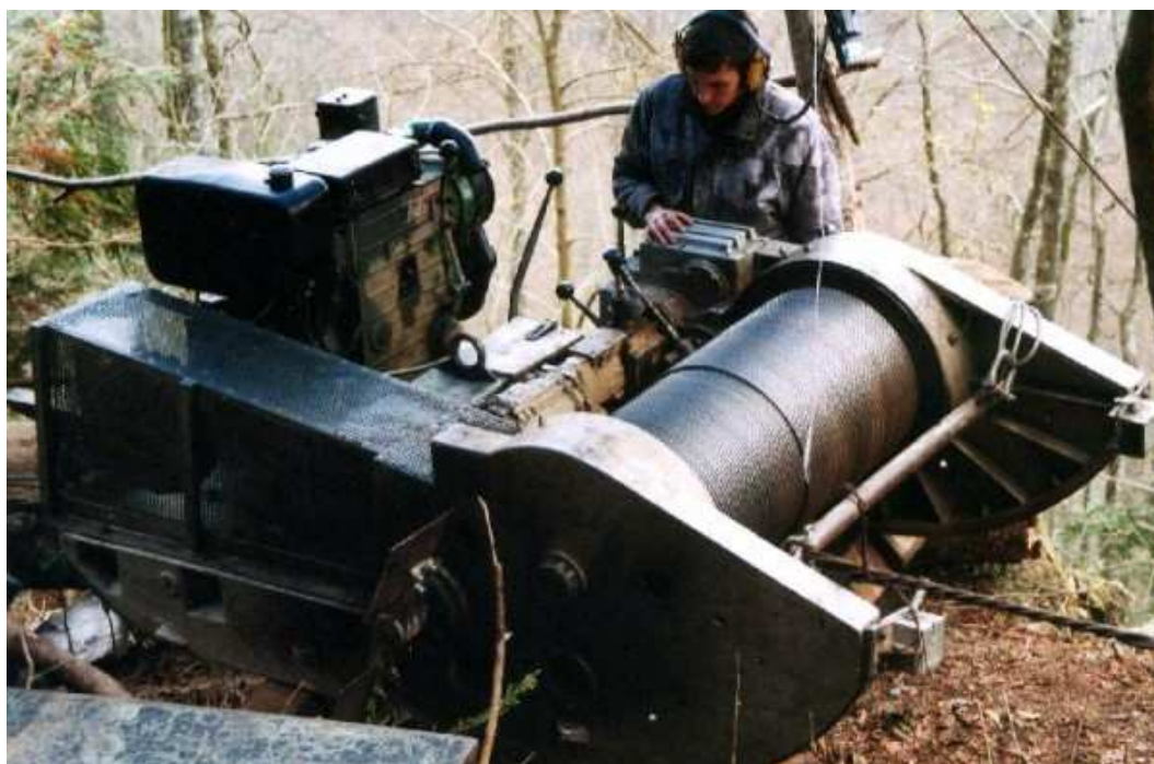
Un exemple commun de câble long sur traîneau/luge. On distingue le tambour recevant le câble tracteur.
