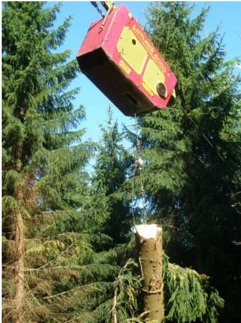
Le débardage vers l'amont d'un épicéa entier à l'aide d'un chariot motorisé
