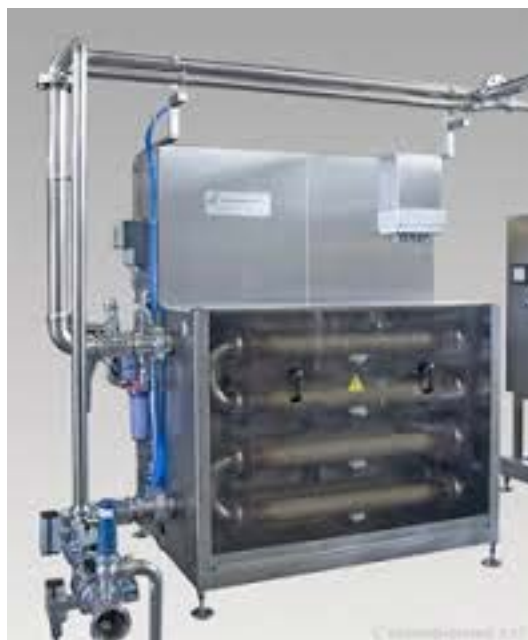
Figure 3 : Installation de chauffage ohmique Multi-étage (source : Emmepiemme)
