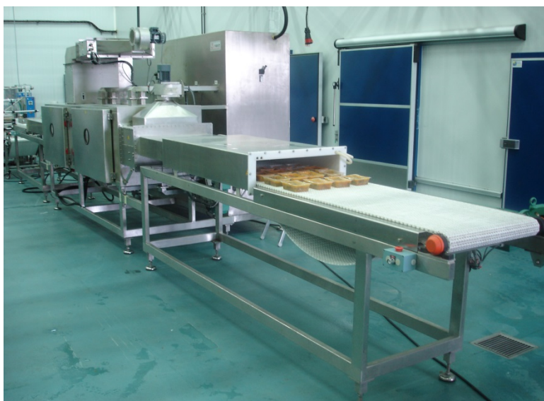
Figure 1 : Tunnel microonde pilote (SAIREM) Application à la pasteurisation de plats cuisinés préemballés en barquettes avec opercule à valve.
