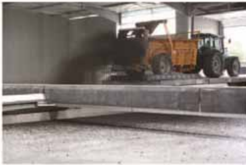
Cemob - Banc automatisé pour l'évaluation des performances d'épandage des engrais organiques
